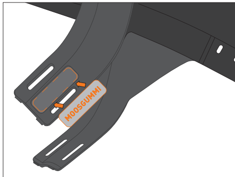
Moosgummi an Radschutz kleben (außen)
